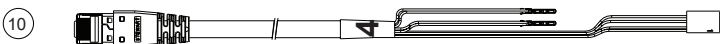
10: 1 X Quest e Flex – Reservatório Chorus – Cabo de Dispensadores Chorus – SP1227 (650 mm)
